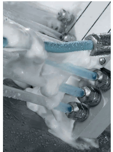
Todo Clean Design, incluyendo las conexiones neumáticas y eléctricas.
