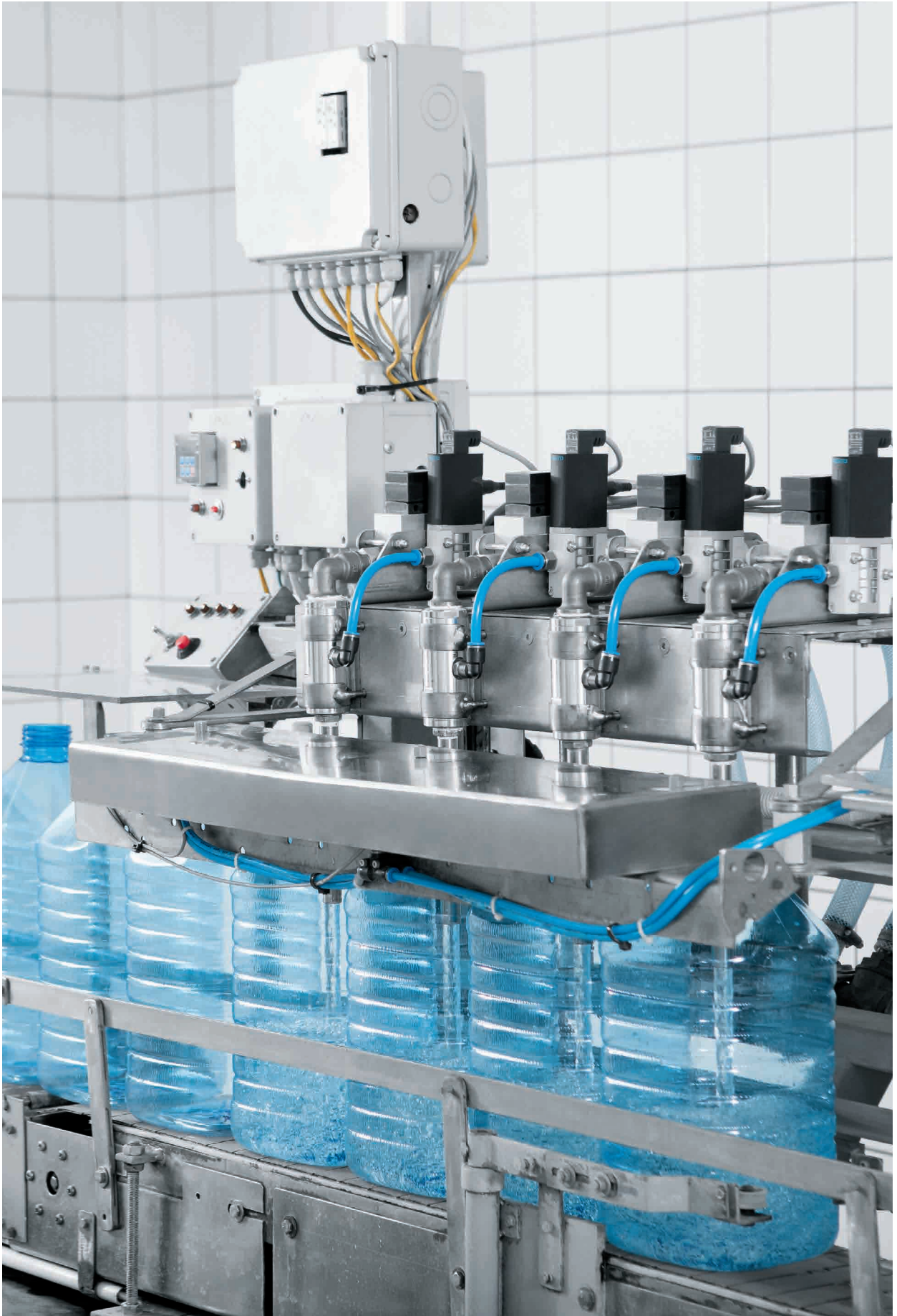
Con la solución de Festo, el embotellamiento de los bidones de 5 litros es muy veloz. Protagonistas: la válvula aprisionadora VZQA y la válvula de respuesta rápida MHE4.
