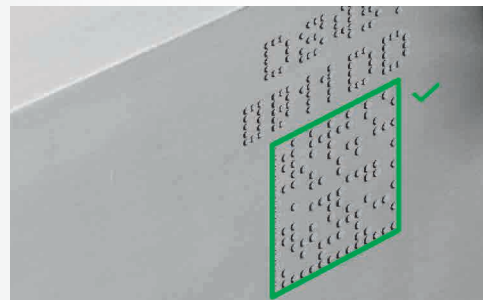
Lectura de códigos Datamatrix, marcados sobre superficies metálicas (por ejemplo, en la industria automovilística)
