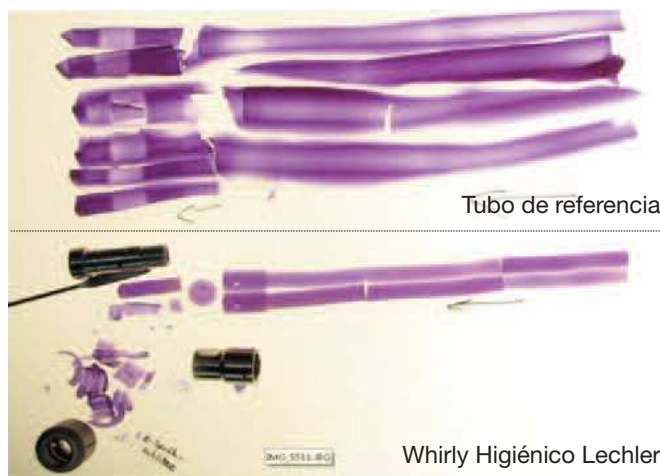
Ilustración 11. Test EHEDG in situ de facilidad de limpieza de un Whirly Higiénico Lechler. El resultado no muestra diferencias entre el tubo de referencia y el Whirly Higiénico. En ambos casos, el color del cultivo es morado, lo que indica que no se han formado gérmenes.
