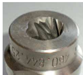
Ilustración 19. Desgaste de una tobera de cono lleno
