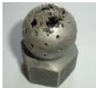
Fig. 1: Corrosión química de una bola de limpieza
