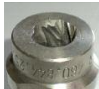
Fig. 2: Desgaste de una tobera de cono lleno
